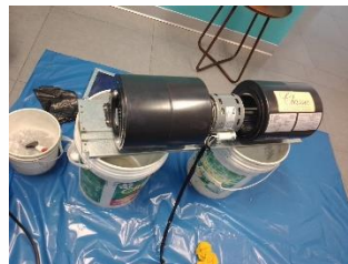
Motores ventilador de Fan Coil (Antes del Mantenimiento)
